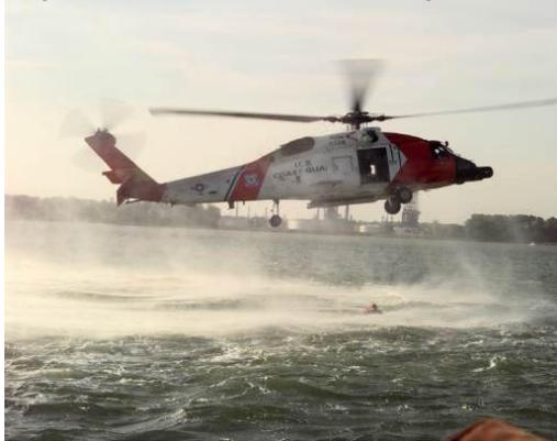
Die reine Such- und Rettungsversion der U. S. Küstenwache, der HH-60J Jayhawk, ist mit Luftbetankungssonde, Rettungswinde und Wetterradar ausgestattet. Diese Version fliegt üblicherweise unbewaffnet, soll aber möglicherweise zur Bekämpfung des Drogenschmuggels mit Maschinenkanonen zum Stoppen der Powerboote der Drogenhändler ausgerüstet werden. Erste Versuche mit anderen bewaffneten Hubschraubertypen verliefen erfolgreich.
